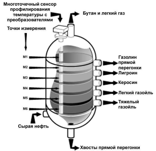
Рис. 2. Дистилляционная колонна/ректификационная колонна
