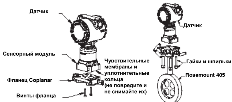
Рисунок 2-2. Болтовое соединение первичного элемента 405 с датчиком
