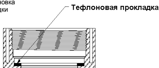
РИСУНОК 3-7. Монтаж датчика модели 2090P с помощью приварной втулки
