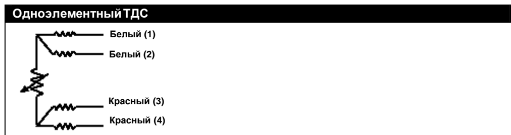
Рисунок 2-2. Конфигурации соединения проводов ТДС серии 68Q, 78 для стандартного диапазона температуры и серии 58С
