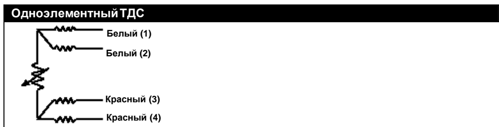
Рисунок 2-3. Конфигурации соединения проводов ТДС серии 65, серии 78 для высоких температур и серии 68
