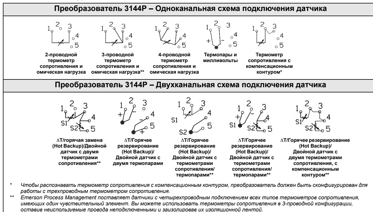
Рис. А-2. Схема соединений FOUNDATION fieldbus
