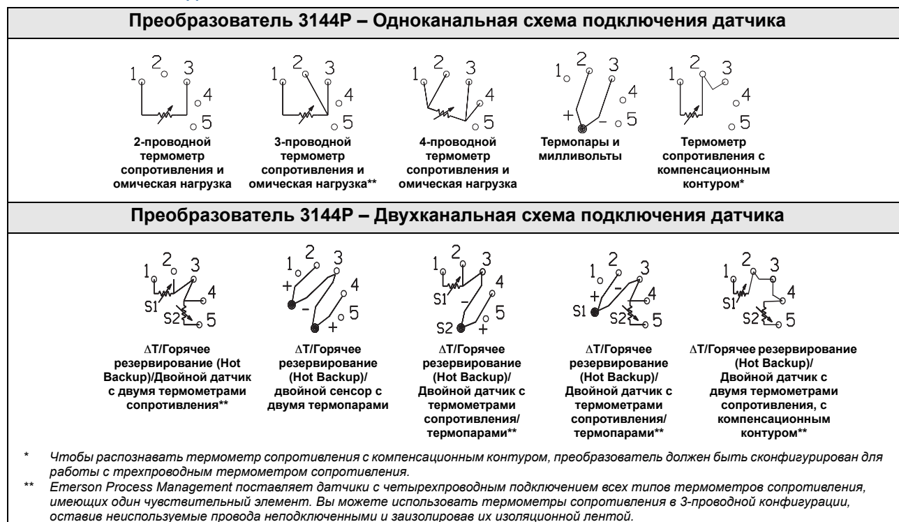
Рис. А-1. Схема соединений HART/4–20 мА
