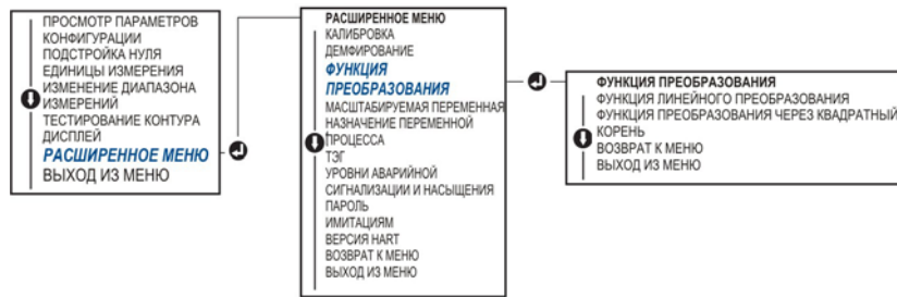
Рисунок 2-5. Установка типа выходного сигнала с помощью локального интерфейса оператора
