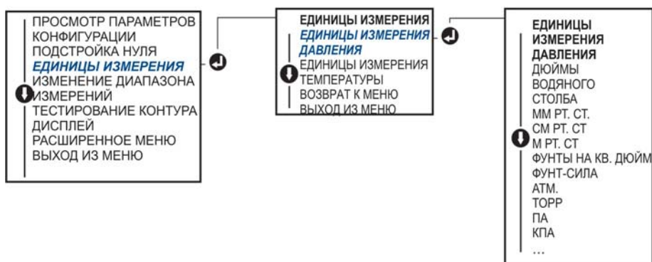
Рисунок 2-4. Выбор единиц измерения с помощью локального интерфейса оператора (LOI)
