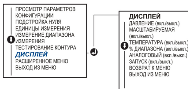
Рисунок 2-11. Конфигурация дисплея с помощью локального интерфейса оператора
