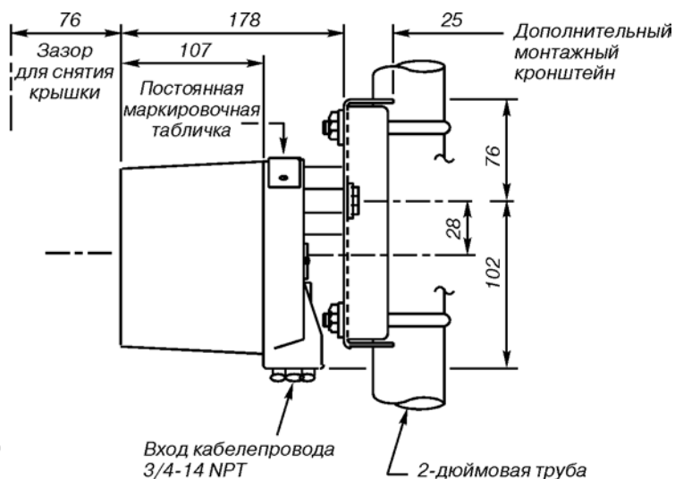
Рис. 3. Габаритный чертеж индикатора Rosemount модели 751.
