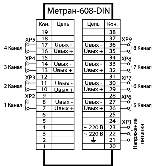
Рис.7. Схема подключения блоков Метран-608 (исполнение DIN).
