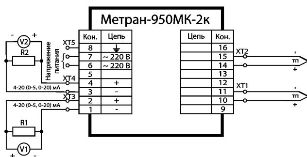
Р1, R2 - сопротивления нагрузки ТП - термопары ХТ5 - напряжение питания, заземление ХТ1, ХТ2 - входной сигнал 1 и 2 каналов соответственно ХТ3, ХТ5 - выходной сигнал 1 и 2 каналов соответственно
