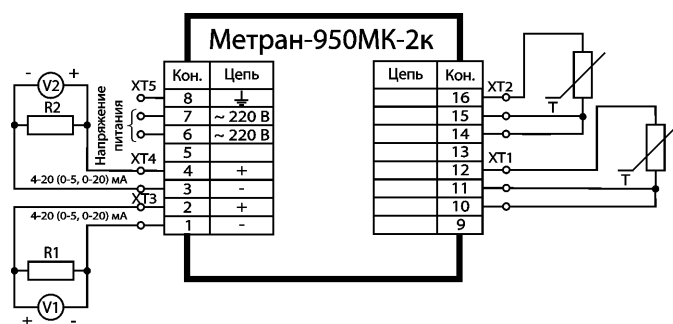
Р1, R2 - сопротивление нагрузки Т - термопреобразователь сопротивления ХТ5 - напряжение питания, заземление ХТ1, ХТ2 - входной сигнал 1 и 2 каналов соответственно ХТ3, ХТ4 - выходной сигнал 1 и 2 каналов соответственно
